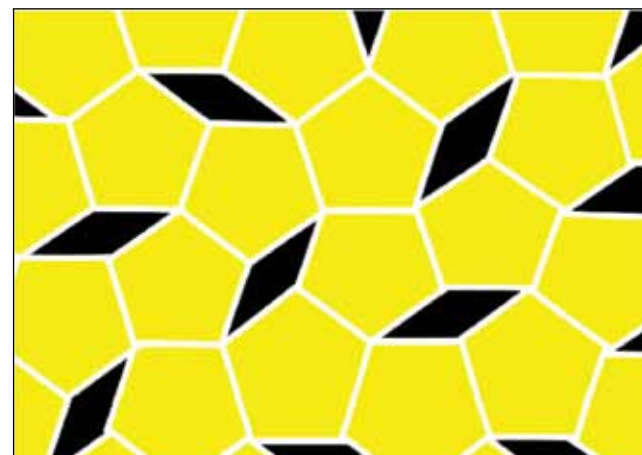
Figura 5: Estrutura cristalina com simetria rotacional de ordem 5. Em tal estrutura é observado que há espaços vazios (losangos pretos), pois não é possível formar uma estrutura cristalina uniforme com simetria rotacional de ordem 5 (pentágonos em amarelo). Em outras palavras, o plano não é preenchido completamente ao se utilizar como base estruturas pentagonais. Limitamo-nos aqui a discutir o caso de tais simetrias no plano.
